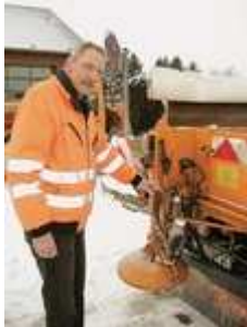
Bauhofleiter Karl Harting am rotierenden Streuteller, der eine vorgegebene Salzmenge auf der Fahrbahn verteilt. Fotos: sig
